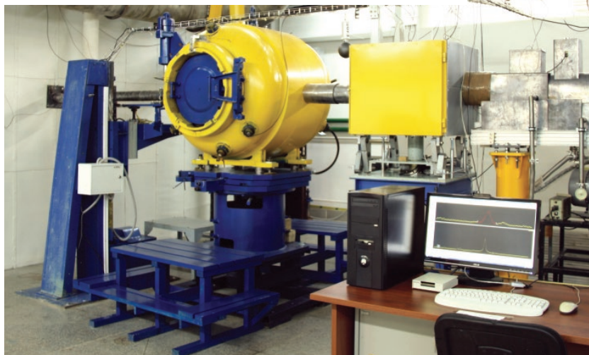
Комплекс для томографии взрывных процессов при помощи синхротронного излучения. Автор: Э.Р. Прууэл.
